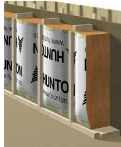
Illustrationen viser væg blæseisoleret, med Træfiberisolering.
