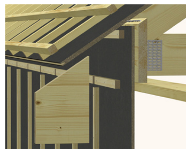
Overgang væg/tag med løs spærrende
